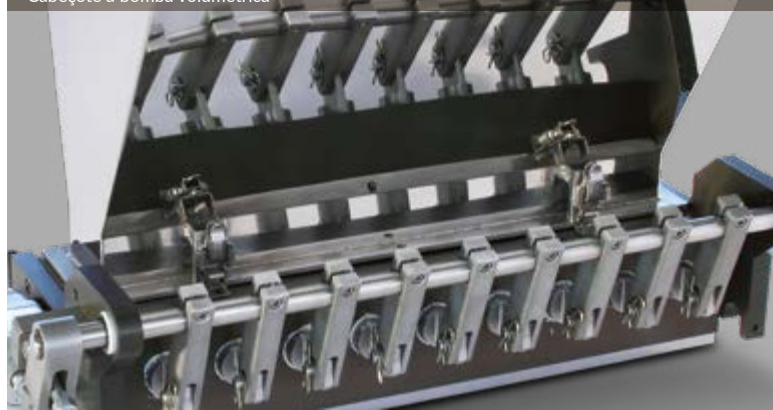
Cabezal a bomba volumétrica Головка с поршневым насосом Cabeçote à bomba volumétrica
