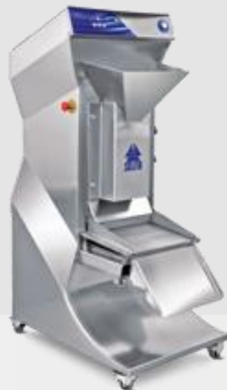
Máquina desenhada para triturar frutas secas e granulá-las.
