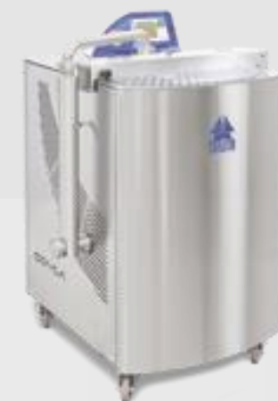
A concha remove a "acidez" negativa e umidade residual, exaltando ao máximo a qualidade e a transformação do chocolate produzido
