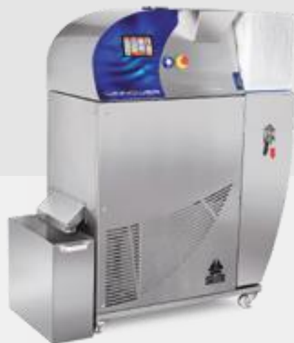
Triturador e separador de casca provenientes do torrador de grãos de cacau, cria nibs de cacau.
