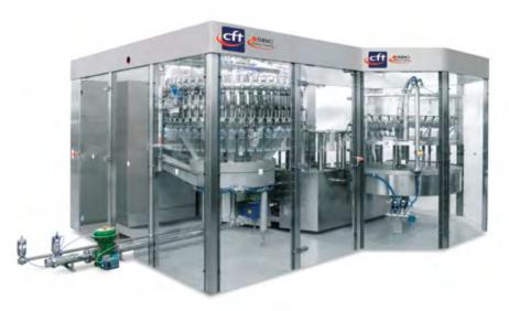
Counter-pressure filling technology suitable for the filling of still and carbonated beverages in Pet bottles. Featuring central tank and neck handling system. Also available as Magic only for still products Technologie à contre-pression pour le remplissage de boissons avec ou sans gaz en bouteille en Pet. Caractéristiques principales : réservoir central et système de prise par le col. La machine existe aussi en version "Magic" uniquement pour produit sans gaz
